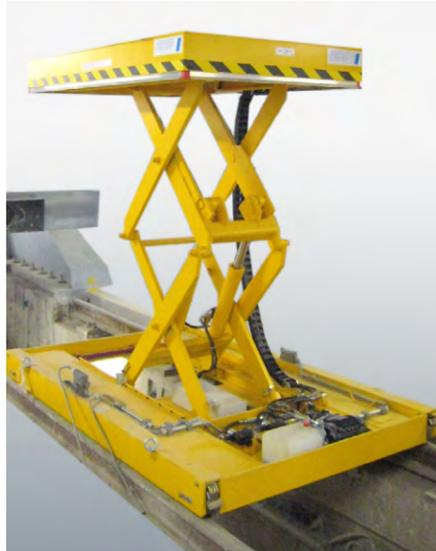
Hubtisch: zum Ausbau von Drehgestellen, Achsen und Komponenten.
