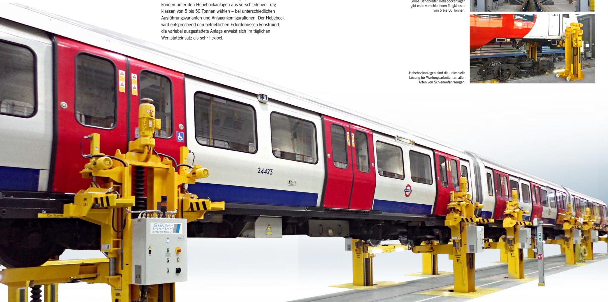
Große Bandbreite: Hebebockanlagen gibt es in verschiedenen Tragklassen von 5 bis 50 Tonnen.
