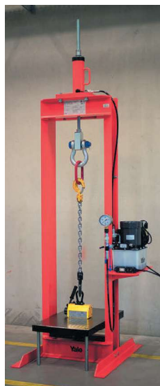
Imán de elevación de carga permanente TPM 0,3 para un ensayo en el banco de pruebas RPYS-1215 completo con la placa de ensayo AYP-1215-S
