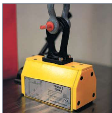
Imán de elevación de carga permanente TPM 0,3 para un ensayo en el banco de pruebas RPYS-1215 completo con la placa de ensayo AYP-1215-S
