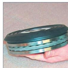
Rodamiento de bolas para la palanca giratoria
