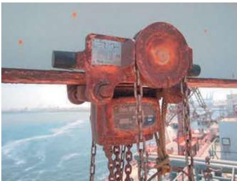
Corrosión en un Yalelift con carro integrado
