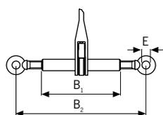
**Ratschlastspanner mit Ausdrehsicherung,**
