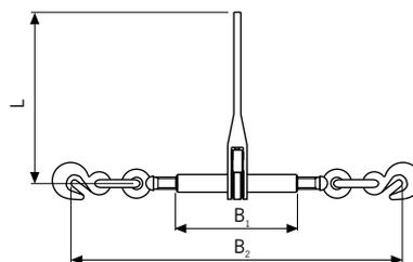
**Ratschlastspanner mit Ausdrehsicherung,**
