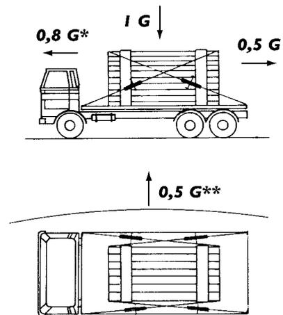
\* Bei kombiniertem Verkehr (LKW und/oder Anhänger per Bahntransport) ist in Längsrichtung mit 1G zu rechnen.
