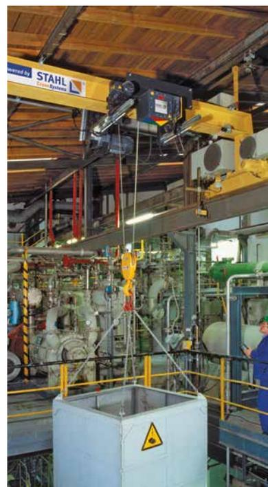
Ein explosionsgeschützter Seilzug SH Ex transportiert Güter durch einen Schacht über mehrere Stockwerke einer chemischen Anlage hinweg. Der Einträgerbrückenkran mit einer Tragfähigkeit von 5.000 kg wird mit einer Funksteuerung bedient.
