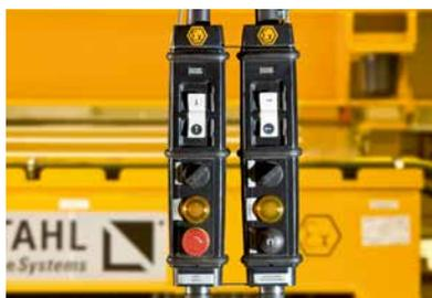
No caso de diferenciais de cabo com proteção antideflagrante para a zona 1 é utilizada a botoneira de comando de dois níveis SWH Ex com a classe de proteção IP66.
