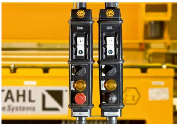
Os aparelhos de comando SWH 5 Ex foram concebidos especialmente para o comando de diferenciais e pontes rolantes em meio explosivo. O acionamento é, regra geral, de 2 níveis e permite uma comutação rápida de »rápido« para »lento« e vice-versa. Todos os aparelhos de comando possuem um botão de paragem de emergência que cumpre a prescrição IEC/EN 60947-5-5.
