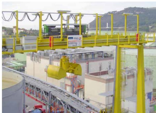
4 Para trabalhos de manutenção nas bombas de tanques de gás liquefeito são utilizados diferenciais especiais para GNL. Os diferenciais de cabo possuem dois tambores para cabos acionados em separado com uma capacidade de carga de 2.400 kg cada. Uma pequena grua giratória adicional está equipada com um diferencial de cabo SH 30 Ex e é utilizada como grua auxiliar para o transporte de ferramentas e componentes para a plataforma do tanque.
