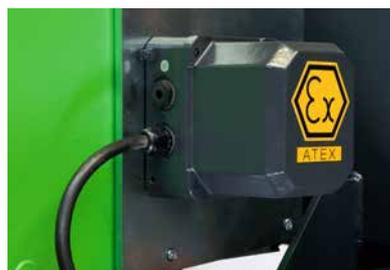
O tipo de proteção do interruptor de fim de curso de engrenagem é IP66. Os elementos de montagem estão protegidos por isolamento à prova de pressão ›db‹ e a caixa por segurança elevada ›eb‹.
