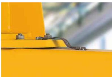
Instalando técnica de pontes rolantes dentro de áreas potencialmente explosivas, é obrigatoriamente necessária uma conexão equipotencial para evitar faíscas inflamáveis.
