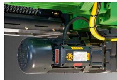
Motores para a zona 1 e zona 21 são de ferro-gusa, o tipo de proteção é uma combinação de blindagem à prova de pressão ›db‹, segurança aumentada ›eb‹ e proteção através de caixa ›tb‹. Para a zona 2 os motores são de alumínio e o tipo de proteção é de meios de produção que não produzem faíscas ›ec‹. Para a zona 22 os motores são em IP66 e possuem proteção através de caixa ›tb‹.
