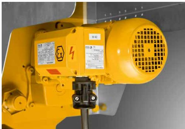
Os acionamentos de translação em versão com proteção antideflagrante para a zona 1 e zona 21 foram concebidos para operação intermitente. Eles possuem um motor de indução correção com travão cónico e massa centrífuga para um comportamento de arranque e de travagem confortável. Todos os motores têm polos comutáveis para, geralmente, duas velocidades de marcha. A engrenagem especialmente silenciosa requer pouca manutenção devido à lubrificação de banho de óleo de longa duração.
