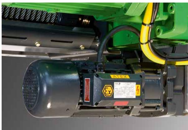
Com cabeceiras com proteção antideflagrante para pontes rolantes suspensas e guias-pontes podem ser construídos sistemas de ponte rolante com uma capacidade de carga de 50.000 kg e uma amplitude de até 30m. Para casos especiais, a pedido do cliente e para maior segurança, todos os rolos e rodas de translação podem ser fornecidos em latão.
