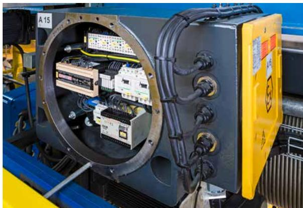
Blindagem à prova de pressão para a zona 1 e zona 2: as caixas de chapa de aço ou alumínio são utilizáveis como caixas individuais ou também como combinações de caixas. Todos os componentes necessários como: transformadores, contactores, fusíveis, instrumentos de medição e dispositivos de desbloqueamento podem ser montados na caixa concebida segundo o princípio modular. Com passagens do fio condutor é estabelecida ligação ao compartimento de conexão (segurança aumentada EX e).
