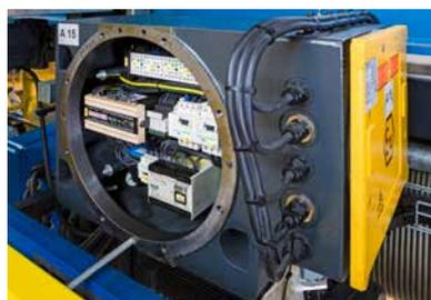
Tipo de proteção das caixas do aparelho na zona 1, zona 2 e zona 21 de pontes rolantes e equipamento de elevação: combinação dos tipos de proteção blindagem à prova de pressão »db«, segurança aumentada »eb« e proteção através de caixa »tb«.
