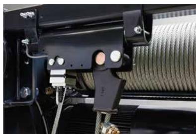
A desconexão por sobrecarga é efetuada com um sensor de carga de dois canais que emite sinais analógicos. Consoante a passagem pelo gorne, são utilizados diferentes sensores (LCD, LSD).
