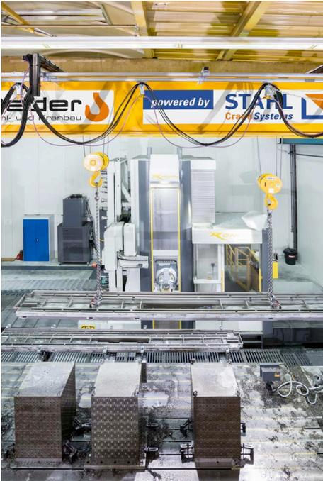
943 mm Bauhöhe ... von der Seite betrachtet verschwinden die Seilzüge komplett hinter der Kranbrücke, nur die Haken sind zu sehen.
