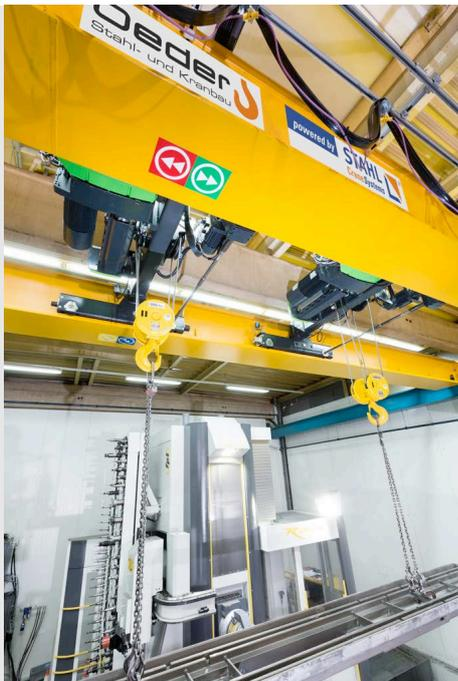
Der Spezialkran ist mit zwei Seilzügen SH mit je 8 t Tragfähigkeit ausgerüstet, die im Tandembetrieb auch lange Lasten sicher heben können.
