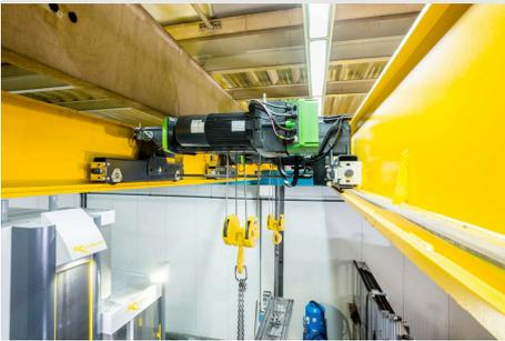
Der Clou: Die kompakten Seilzüge laufen auf einem Spezialfahrzeug zwischen den Kastenträgern.
