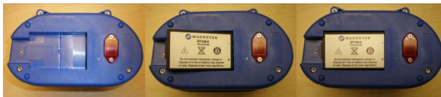
Figura 4: Instalación del paquete de baterías en el transmisor MLTX2
