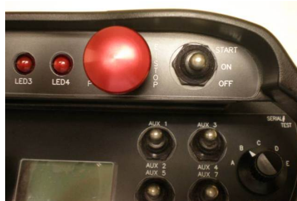
Figura 9: Interruptor de parada de la máquina y conmutador OFF-ON-START (APAGADO-ENCENDIDO-ARRANQUE)
