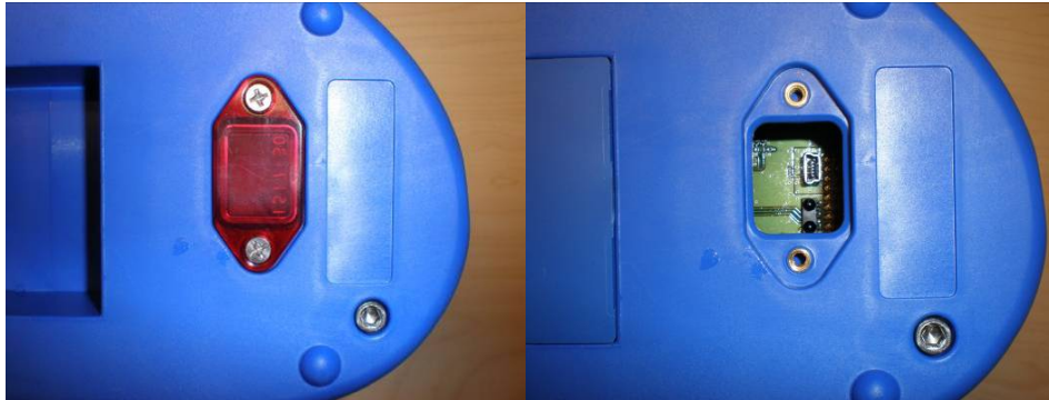
Figura 7: Ubicación de la tapa USB/IR y extracción de la tapa
