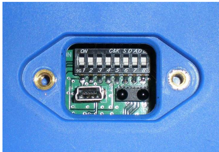
Figura 8: Bloque de interruptores dip como se ven a través del puerto USB/IR
