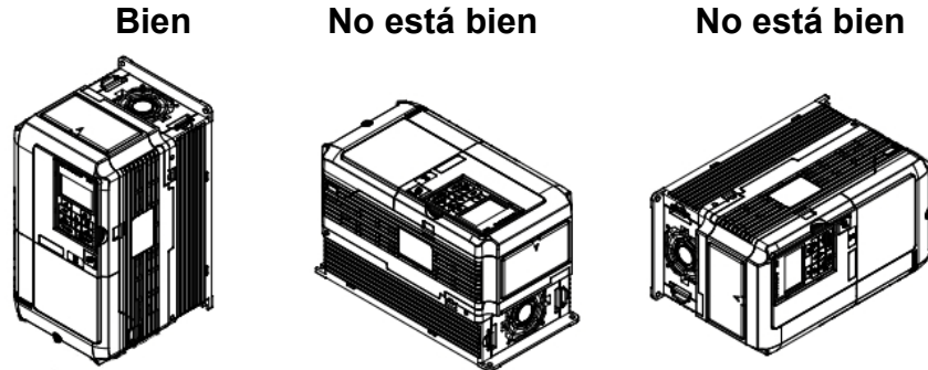
Figura 2-2: Orientación correcta de instalación
